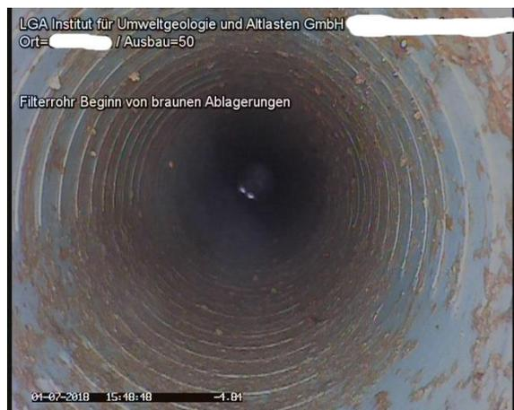
Filterrohr mit braunen Ablagerungen
